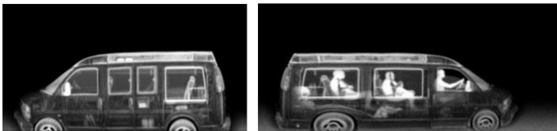
Рис. 70. Изображения, формируемые рассеянным излучением (слева – закладки в полостях автомобиля, справа – лица с оружием в автомобиле)
