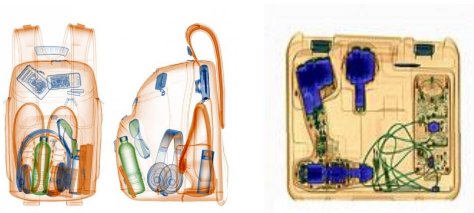
Рис. 9. Выделение объектов из разных материалов различным цветом
