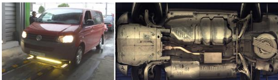
Рис. 38. Изображение днища автомобиля, сформированное комплексом
