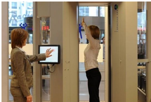
Рис. 48. Досмотр человека обратно рассеянным рентгеновским излучением
