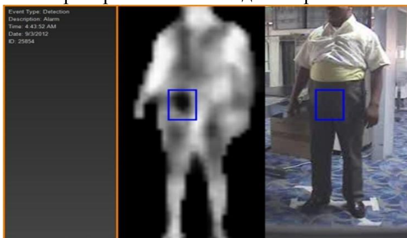
Рис. 85. Отображение скрытого опасного предмета на изображении, полученном с помощью WaveScan
