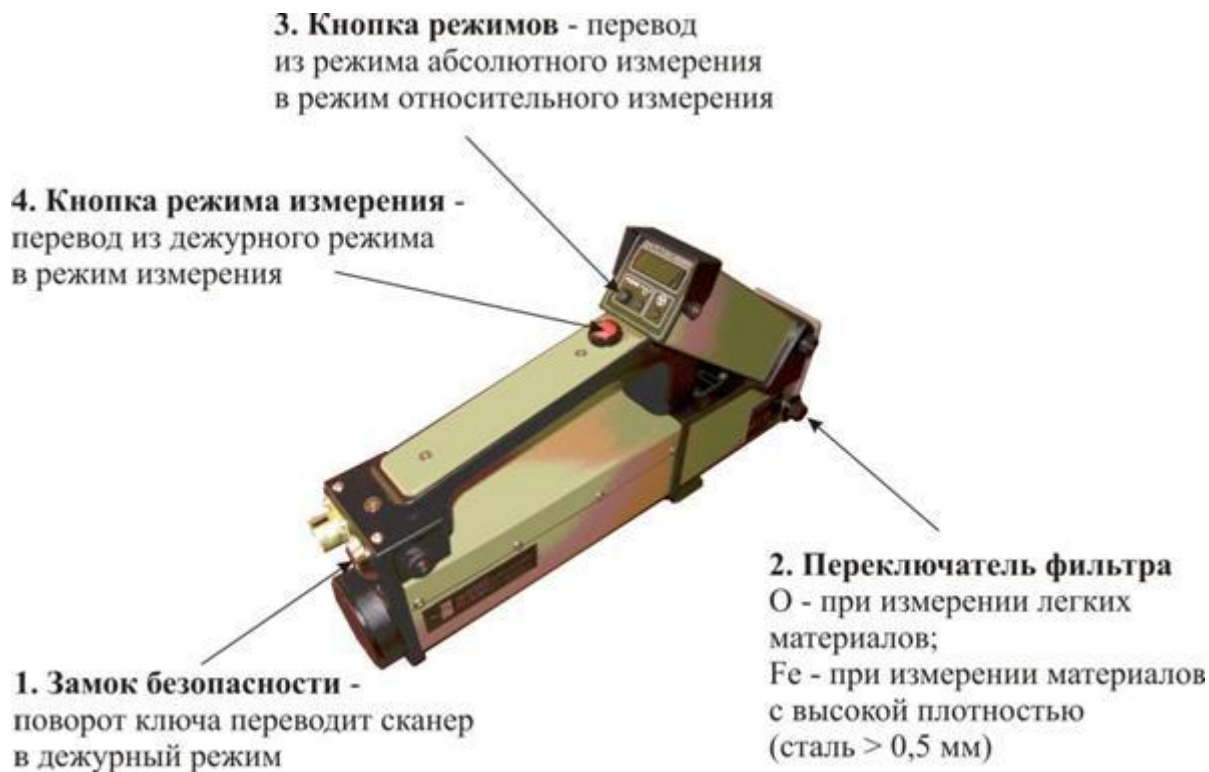
Рис. 79. Органы управления сканера «Ватсон»
