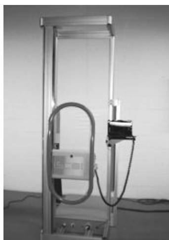
Рис. 61. Конструкция инфракрасного сканера Iscon-минипортал (слева) и полученное изображение скрываемых таблеток
