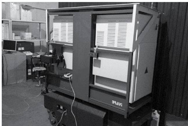
Рис. 33. Аппаратура зондирования быстрыми «мечеными» нейтронами
