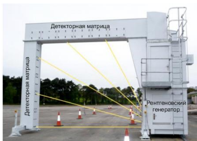
Рис. 5. Генераторная и детектирующая части инспекционно-досмотрового комплекса
