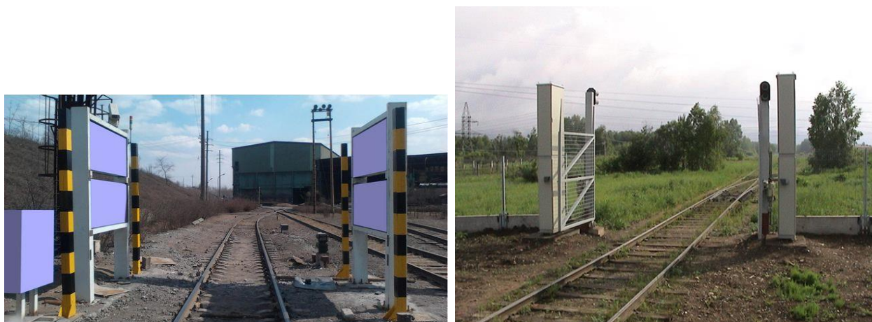
Рис. 18. Варианты конструктивного исполнения радиационных мониторов
