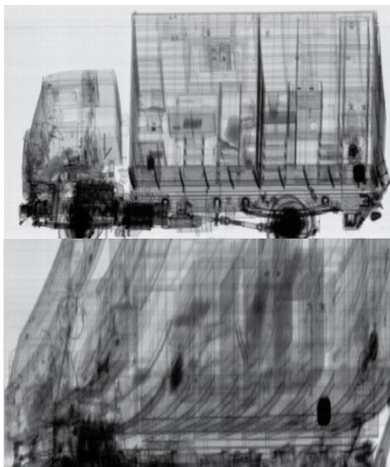
Рис. 32. Рентгеновские изображения досматриваемого автомобиля в двух ракурсах
