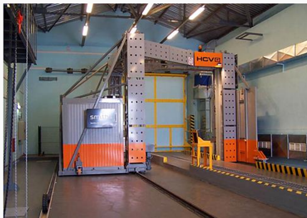
Рис. 20. Размещение оборудования стационарного ИДК для досмотра автотранспорта
