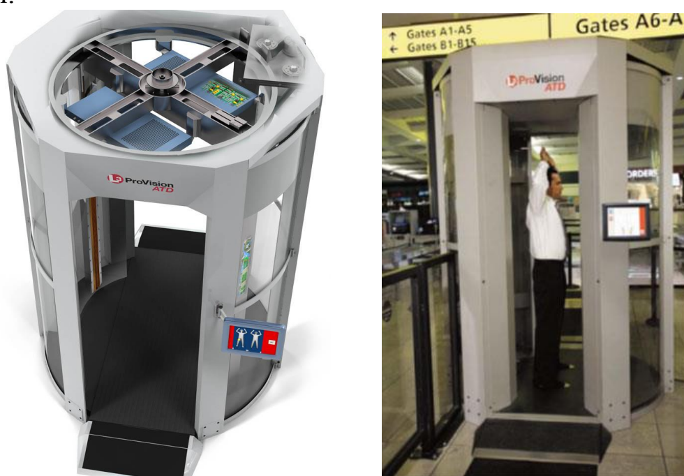
Рис. 54. Внешний вид установки ProVision ATD и процесс досмотра
