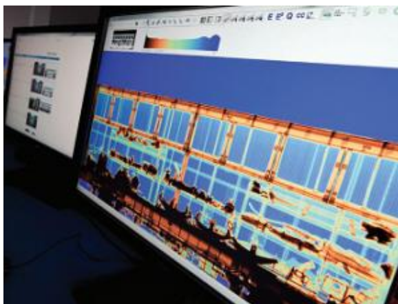
Рис. 14. Удалённый пост контроля комплекса Rapiscan Eagle R60
