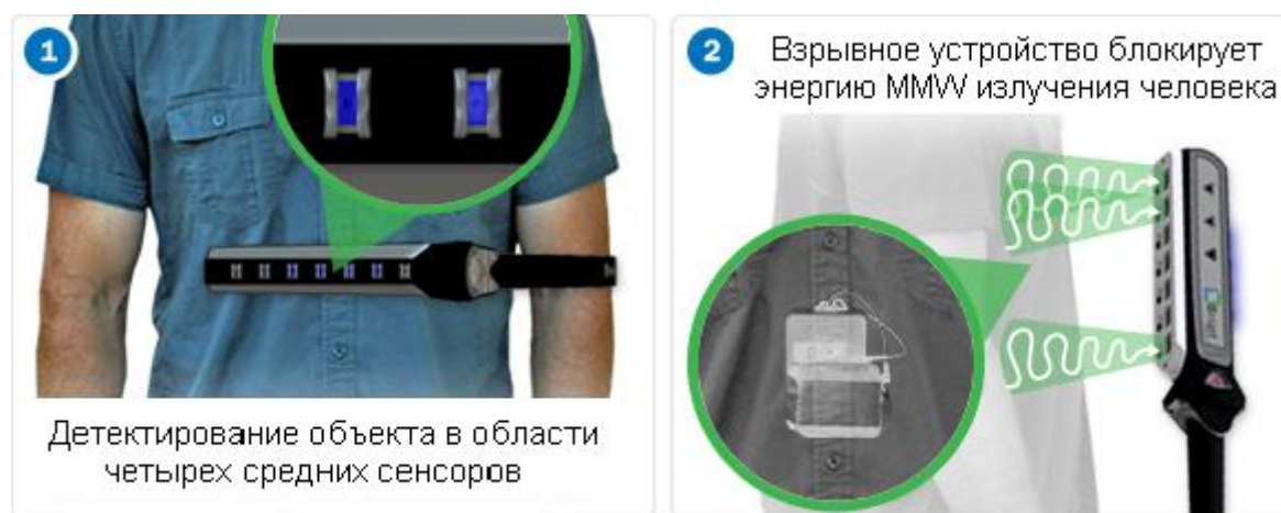
Рис. 86. Принцип работы портативного сканера миллиметровых волн
